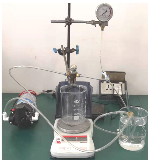
图1 交叉错流式过滤系统实验装置照片
