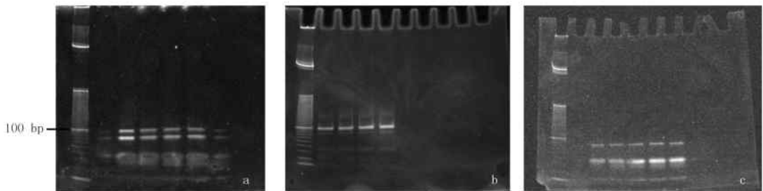
(a) 表示连接温度在 20 \sim 22 \text{ }^{\circ}\text{C} ; (b) 表示连接温度在 25 \text{ }^{\circ}\text{C} ; (c) 表示连接温度在 28 \sim 30 \text{ }^{\circ}\text{C} .
