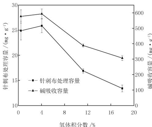
(碱液质量分数:3%; 气体流量:3 L/min; 增重率:(148.5±3.0)%; 温度:(8±2) °C; H<sub>2</sub>S 质量浓度:(270.6±16.4) mg/m<sup>3</sup>)
