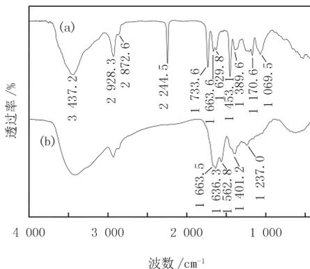
图2 腈纶针刺布(a)和多胺基腈纶针刺布(b)的红外光谱图
