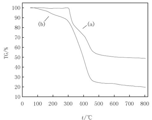
图3 腈纶针刺布(a)和多胺基针刺布(b)的热失重曲线
