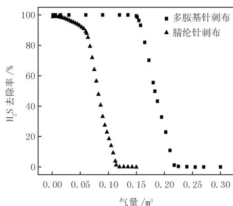
(碱液质量分数:3%; 气体流量:3 L/min; 增重率:(148.5±3.0)%; 温度:(29±1) °C;  $H_2S$  质量浓度:(270.6±16.4) mg/m<sup>3</sup>; 氧的体积分数:(1.0±0.5)%)
