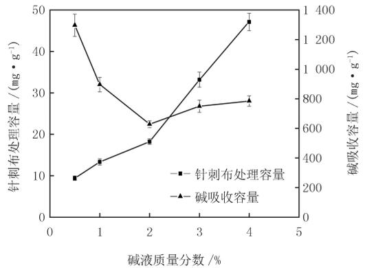
(增重率:  $(148.5 \pm 3.0)\%$ ; 气体流量: 3 L/min; 氧的体积分数:  $(1.0 \pm 0.5)\%$ ; 温度:  $(29 \pm 1)^\circ\text{C}$ ;  $\text{H}_2\text{S}$  质量浓度:  $(270.6 \pm 16.4) \text{ mg/m}^3$ )
