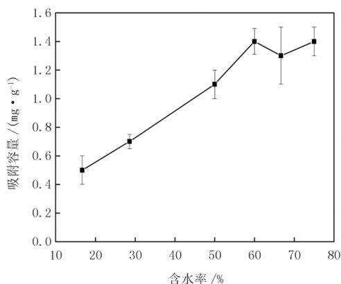
(气体流量:3 L/min; 氧的体积分数:(1.0±0.5)%; 温度:(29±1) °C;  $H_2S$  质量浓度:(270.6±16.4) mg/m<sup>3</sup>)
