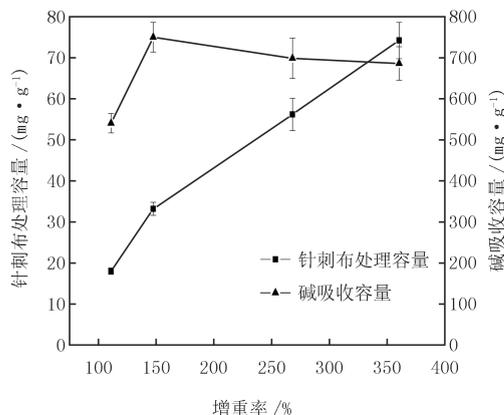
(碱液质量分数:3%; 气体流量:3 L/min; 氧的体积分数:(1.0±0.5)%; 温度:(29±1) °C; H<sub>2</sub>S 质量浓度:(270.6±16.4) mg/m<sup>3</sup>)
