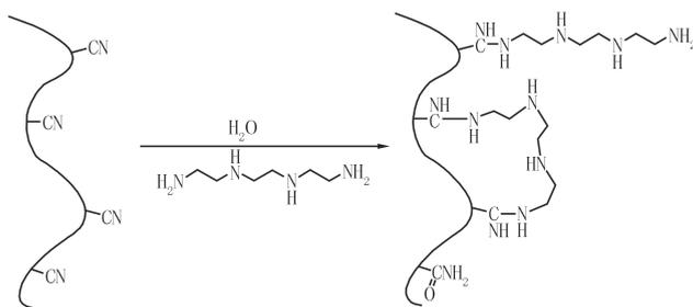
图 1 多胺基腈纶针刺布的制备反应机理
