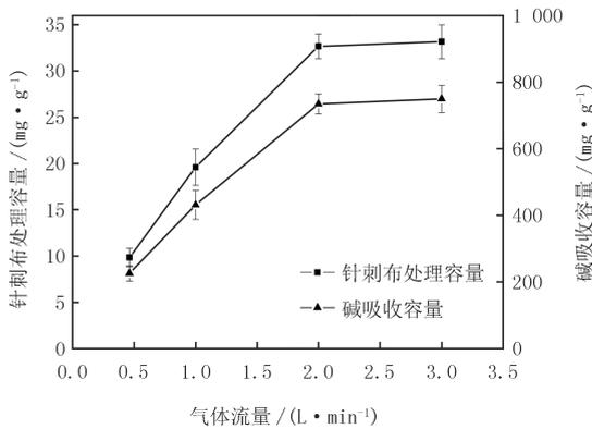
(增重率:  $(148.5 \pm 3.0)\%$ ; 碱液质量分数: 3%; 氧的体积分数:  $(1.0 \pm 0.5)\%$ ; 温度:  $(29 \pm 1)^\circ\text{C}$ ;  $\text{H}_2\text{S}$  质量浓度:  $(270.6 \pm 16.4) \text{ mg/m}^3$ )
