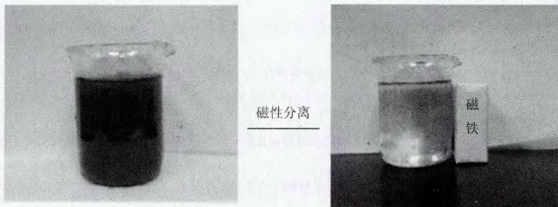
图9 \text{Fe}_3\text{O}_4/\alpha\text{-Fe}_2\text{O}_3 在外加磁场作用下的分离效果
