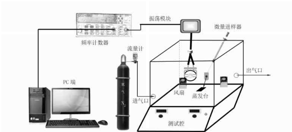
图2 石英晶体微天平气敏测试系统
